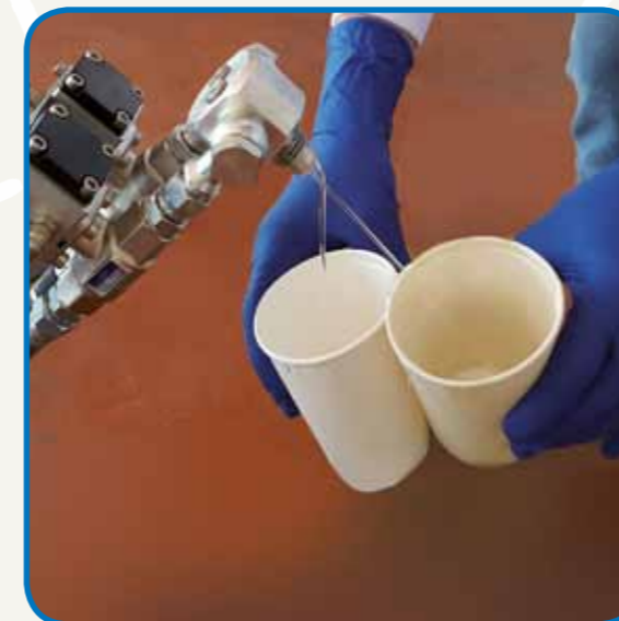
■ Controllo del rapporto possibile anche durante la produzione ■ Ratio control during the production
