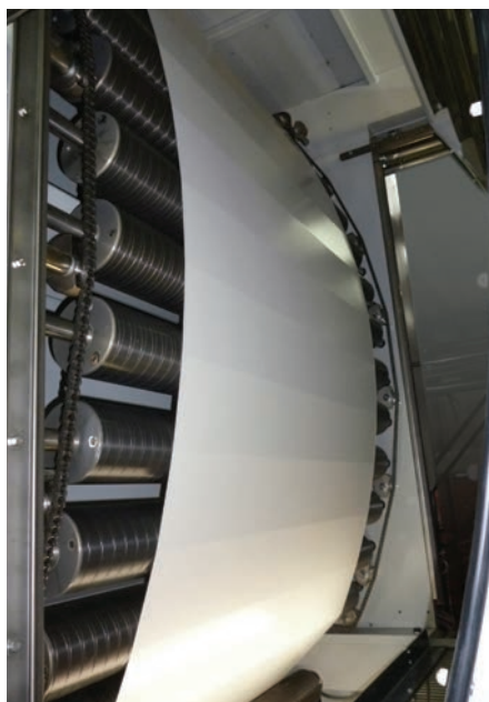
High efficiency vertical drying hood Cappa di asciugamento verticale ad alta efficienza Vertikale Hochleistungstrocknungshaube
