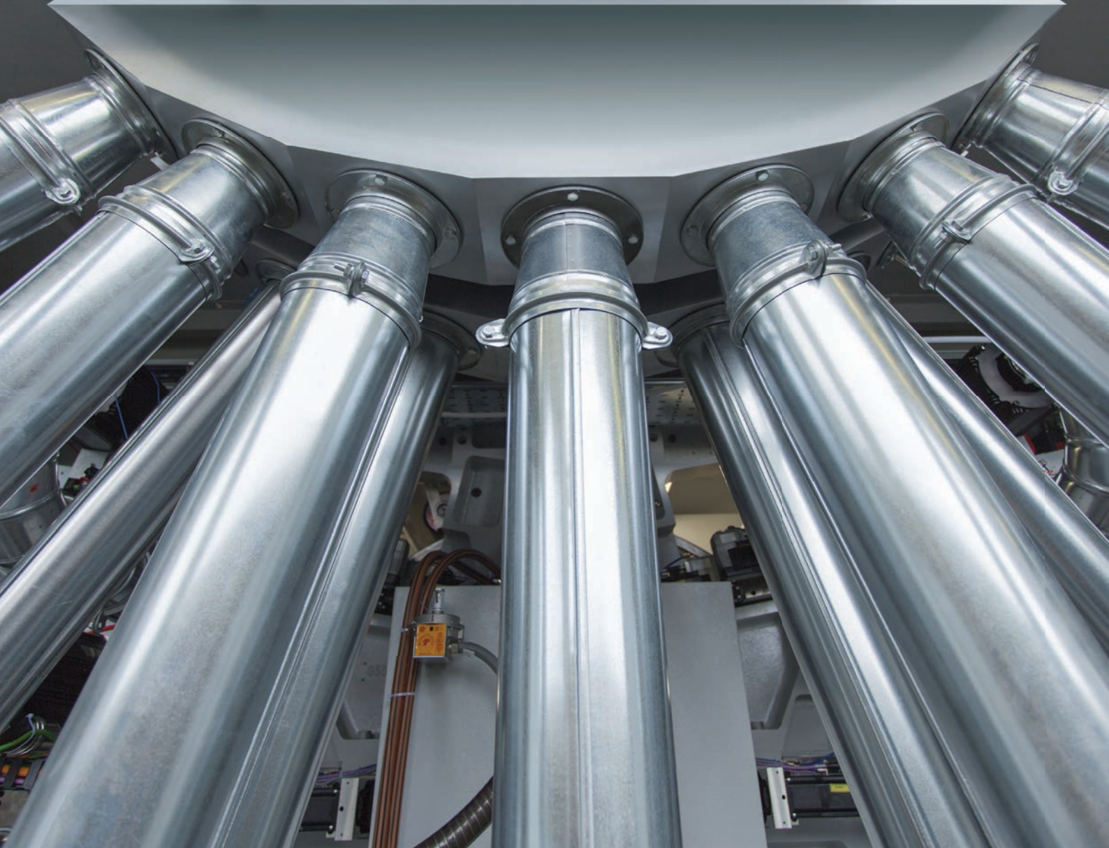
Air distribution system in-between colours Sistema distribuzione aria elementi colore Luftverteilungssystem Zwischentrocknung
